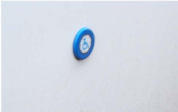
**Abbildung 3: visuell kontrastierender Anforderungstaster an der Fahrzeugaußenseite**
